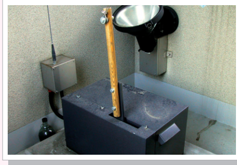
「鐘を鳴らす機械」 木でできている柄の部分が動くことで鐘を打つ仕組みになっている
