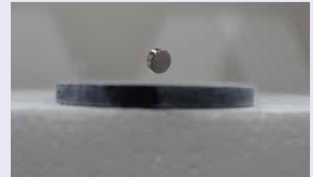
マイスナー効果によって円盤状の超伝導体の上に浮上しているネオジム磁石 The Meissner effect causes a neodymium magnet to levitate above a disc-shaped superconductor.
