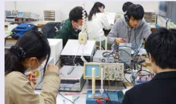
オシロスコープを用いてコイルのインピーダンスを測定する実験の様子 Students use an oscilloscope to measure the impedance of a coil during an experiment lesson.
