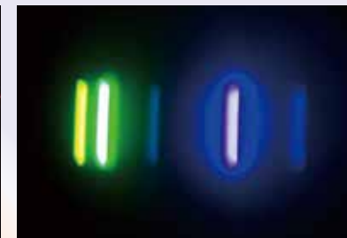
プリズム分光器による水銀(Hg)原子のスペクトル This mercury (Hg) atom spectrum was produced using a prism spectroscope.
